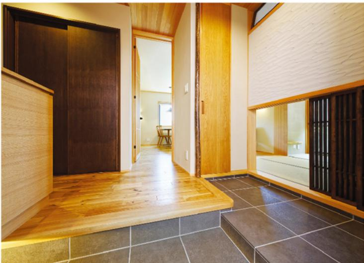
間取り変更なし。押入れを撤去し玄関を拡張。壁に欄間と開口を設け、和室を風の通り道として計画。
