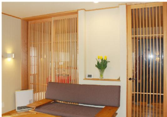
リビングの視線を妨げる下がり壁を撤去し、引き戸を天井までの高さのガラス格子の引込み戸にすることで、戸が内壁に入り、空間を有効に使えるように。部屋を閉め切っても、ガラス格子の建具は視覚的に奥行きがあるので圧迫感を感じさせません。
